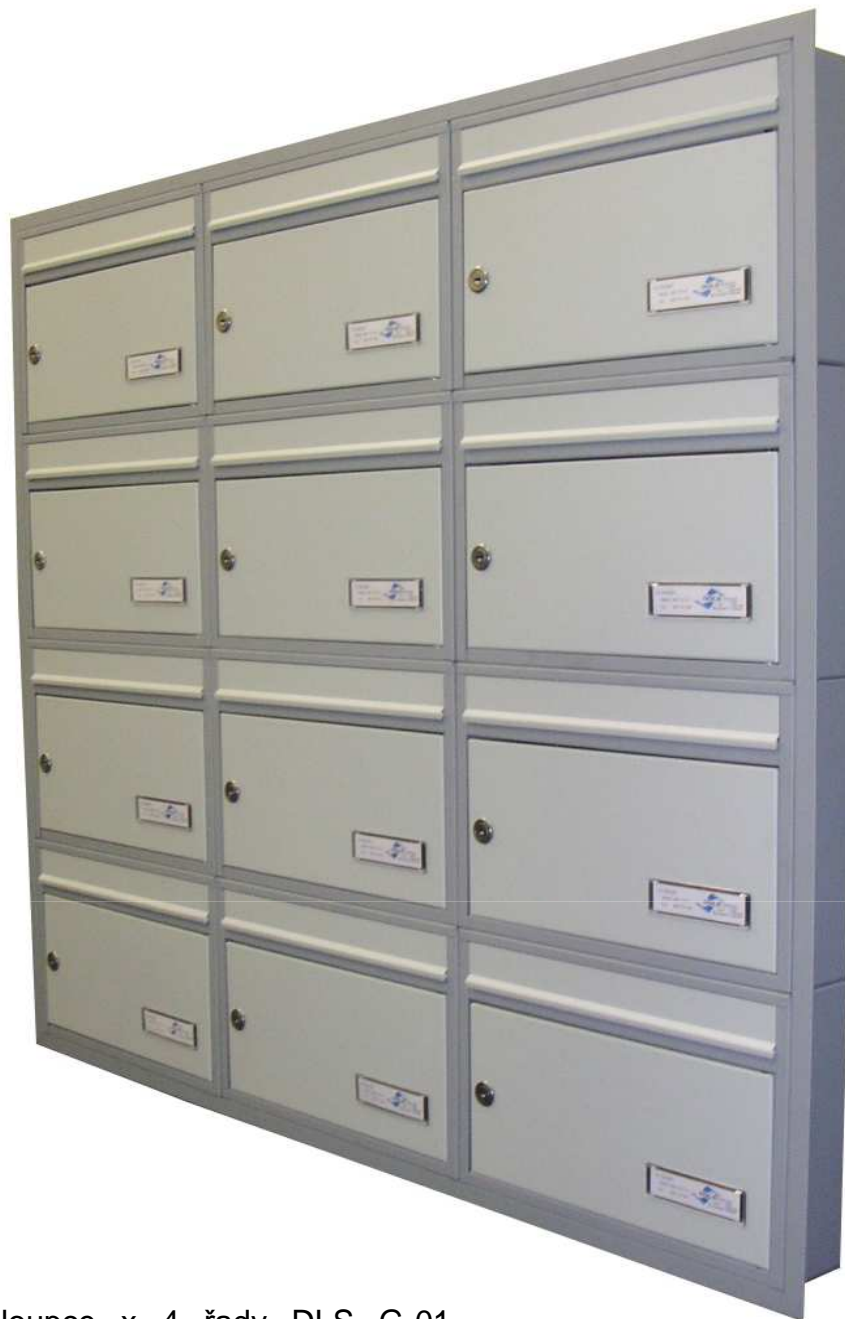
Sestava pro zazdění, 3 sloupce x 4 řady DLS G-01 (385x260x80), schránky snýtovány do bloku a orámovány po obvodu L 20/20/2.
